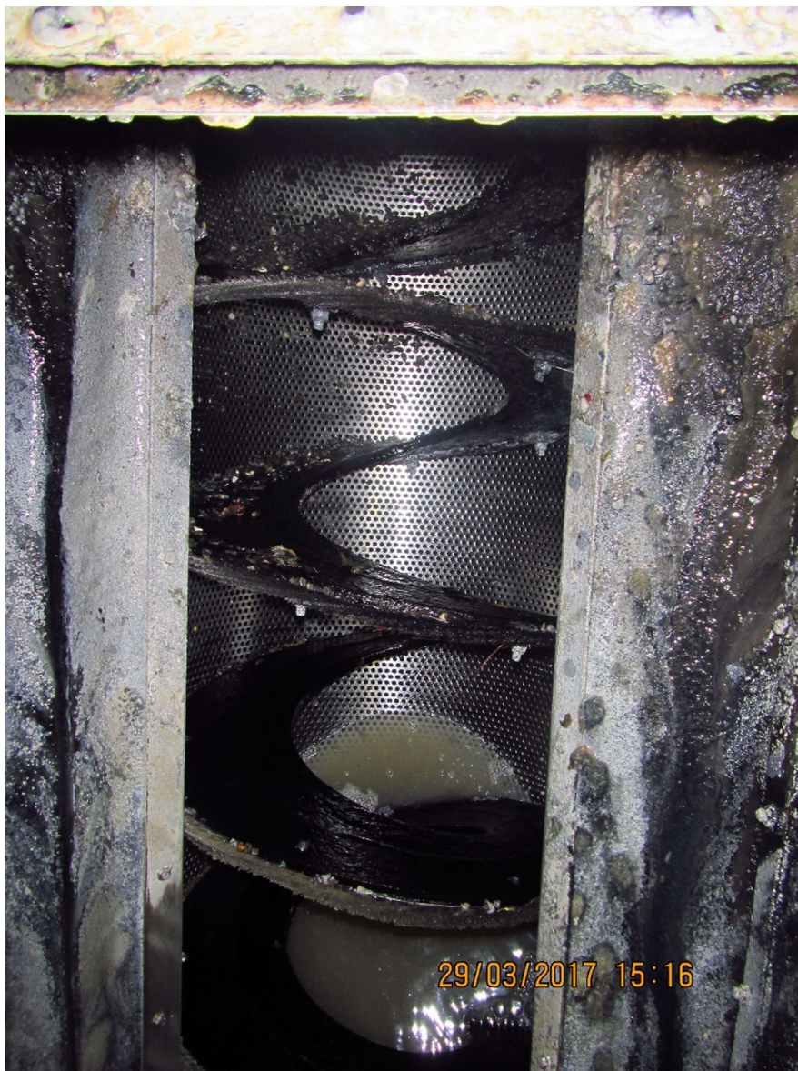
Perforacja sita: 6 mm zamiast 2 mm
